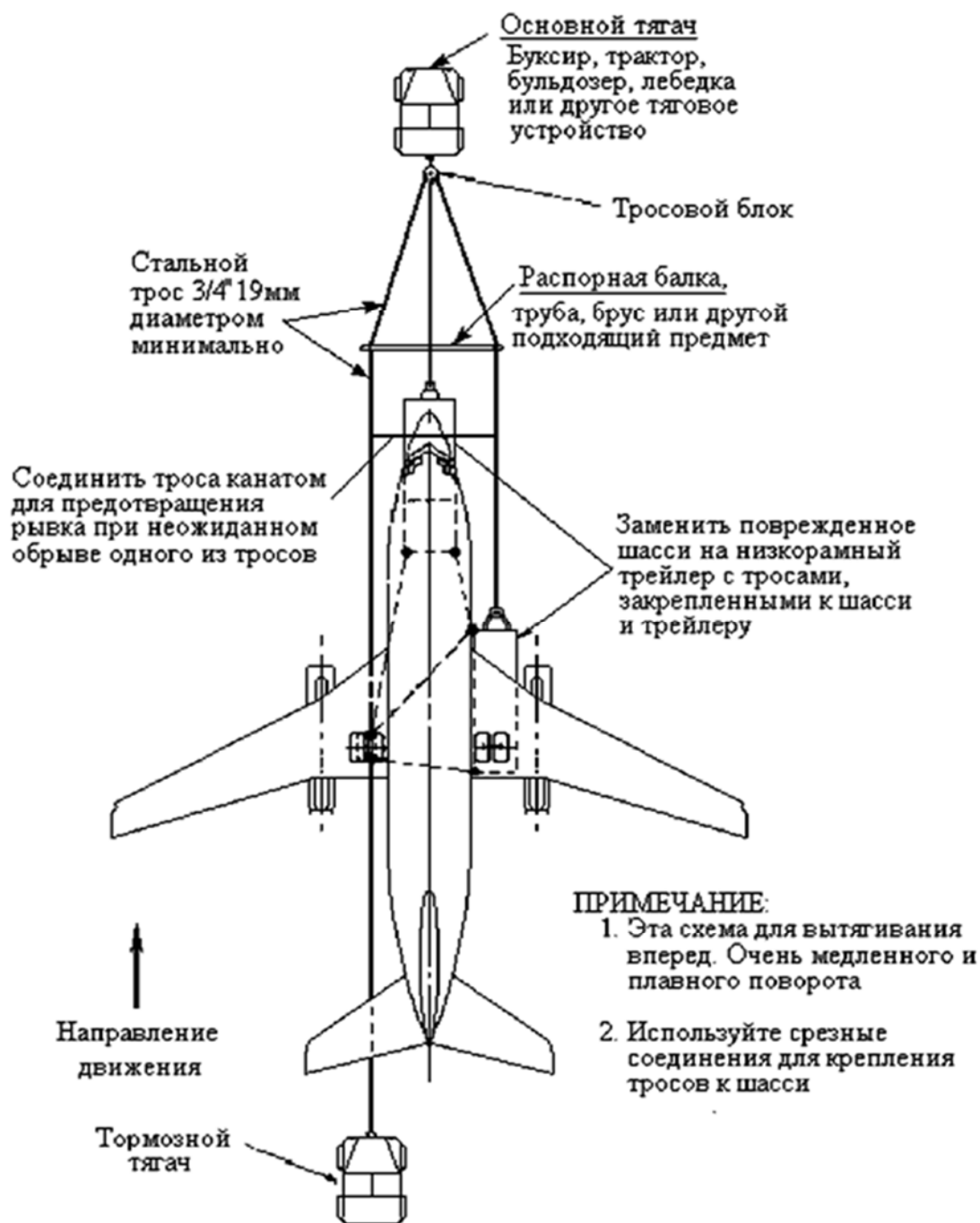
Рис. 5-7 Раскладка буксирных тросов
