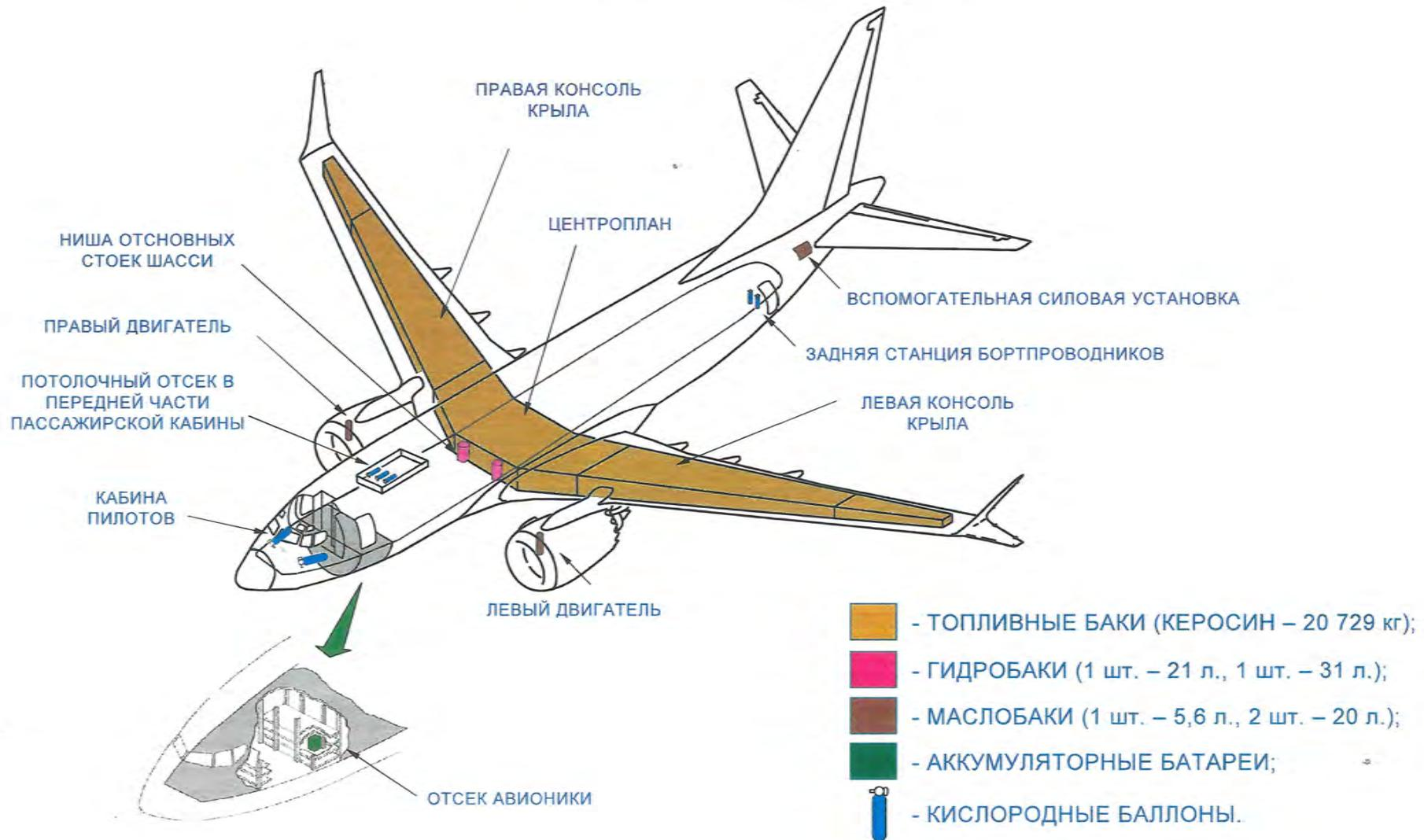
**СХЕМА АВАРИЙНО-СПАСАТЕЛЬНОЙ МАРКИРОВКИ САМОЛЕТА BOEING 737 MAX АО «АВИАКОМПАНИЯ «СИБИРЬ» ДЛЯ АВАРИЙНО-СПАСАТЕЛЬНЫХ СЛУЖБ И ФОРМИРОВАНИЙ АВИАПРЕДПРИЯТИЙ.**
